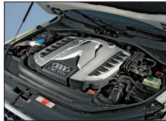
Der einzige seiner Art: Zwölfzylinder-Diesel. Die technische Basis bildet der drei Liter große Sechszylinder
